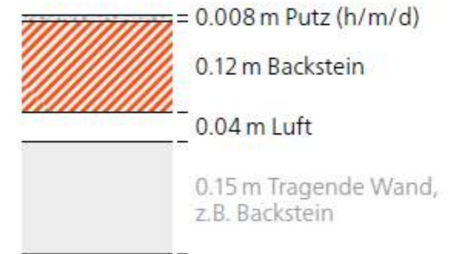
Zweischalenmauerwerk verputzt → ZW_Zweischalenmauerwerk_Luftschicht
