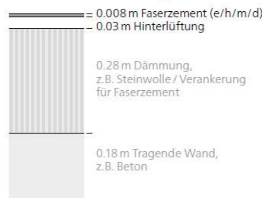
Faserzementverkleidung, Eternit → HF_Faserzementverkleidung
